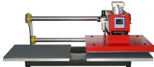
La presse à chaud **FL-DX7** est pneumatique et évolutive, à double plateaux pour le transfert sur textiles et autres supports plats de format 40 x 50cm. La pression est générée par de l'air comprimé (nécessite un compresseur), la descente et la remontée du plateau supérieur s'effectue automatiquement.
